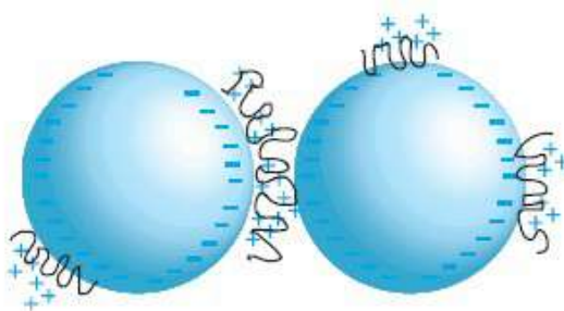
Figura 3 – Coagularea cu polimer cu greutate moleculara scazuta
